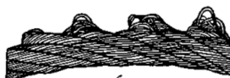
Рис.5 – Выдавливание проволок прядей: а — в одной пряди; б — в нескольких прядях
